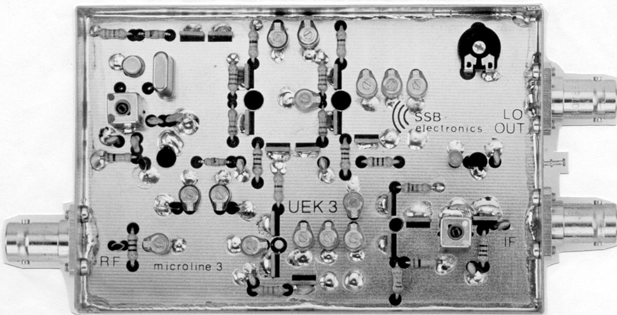
Dieser neu entwickelte Konverter-Baustein aus der Serie " microline 3 " beinhaltet eine Injektions-Frequenzaufbereitung zur Versorgung eines externen Sendemischers und zur Ansteuerung des eingebauten GaAs-Fet-Empfangsmischers.
